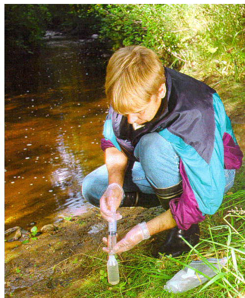
Figure 12. Filtration of a stream water sample (photo: Jari Väätäinen, GTK, from Salminen, Tarvainen et al. , 1998, Fig. 6, p.17)
